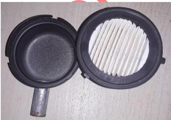
Le filtre d'aspiration permet d'éliminer les poussières présentes dans l'air aspiré par le compresseur. Ce filtre est particulièrement important pour protéger les cylindres du compresseur contre les rayures, ce sont des filtres secs en carton que l'on trouve très facilement dans l'industrie automobile.
